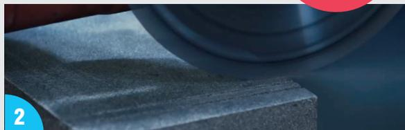
2 Mehrere, intensive und flache Schärfschnitte in Segmenthöhe durchführen bis die Gruben nicht mehr sichtbar sind. Zur Materialersparnis nur in Segmenttiefe eintauchen, nicht durchtrennen.
