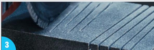
3 Nach einigen Schnitten die Maschine mehrmals mit leichtem Druck in die Schärffplatte auslaufen lassen. Den Vorgang (Punkt 2-3) mehrfach wiederholen bis neue, kantige Diamanten mit Stützwelken freigelegt sind.
